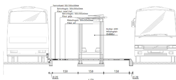
Dwarsprofiel B3: Standaard dubbel perron in lijn volgens HIOR schaal 150
