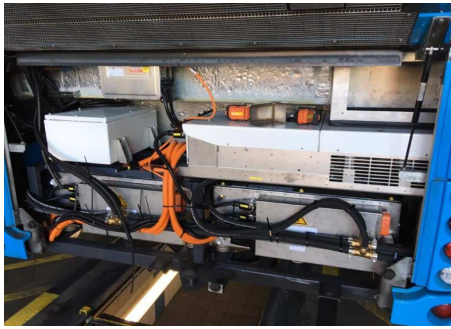
Nieuwe ingebouwde accupakken in een bestaande enkele gelede trolleybus
