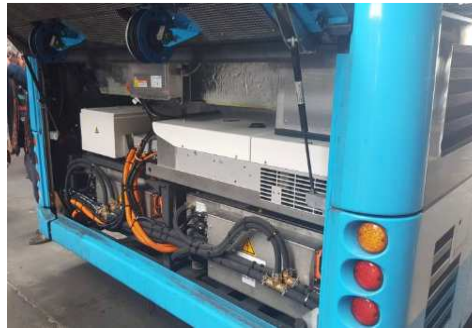
Nieuwe ingebouwde accupakken in een bestaande enkele gelede trolleybus
