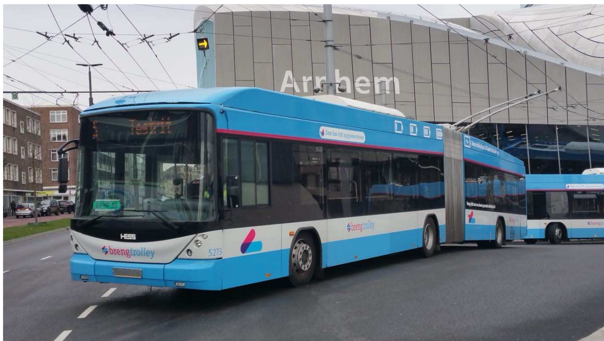
Figuur 1: Een trolley2.0-bus op Arnhem Centraal Station. Tijdens het stilstaan zijn de batterijen bijgeladen, wat voortgezet wordt tijdens het rijden onder de draad. Op die manier hoeft er geen additionele laadtijd buiten de dienstregeling ingepland te worden.
