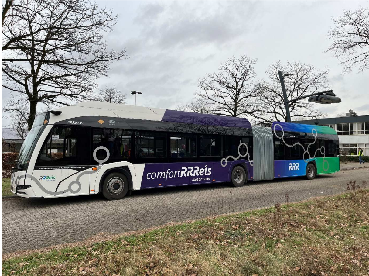
Figuur 2: De nieuwe trolley2.0-bussen van het merk Solaris, die in 2024 de Rijnlijn zullen gaan bedienen. Met de inzet van deze voertuigen wordt de potentie van de trolley2.0-techniek ook tastbaar voor aan Arnhem grenzende gemeentes.
